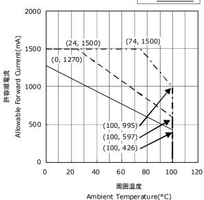
カソード側はんだ接合部温度-許容順電流特性 Solder Temperature(Cathode Side) vs Allowable Forward Current
